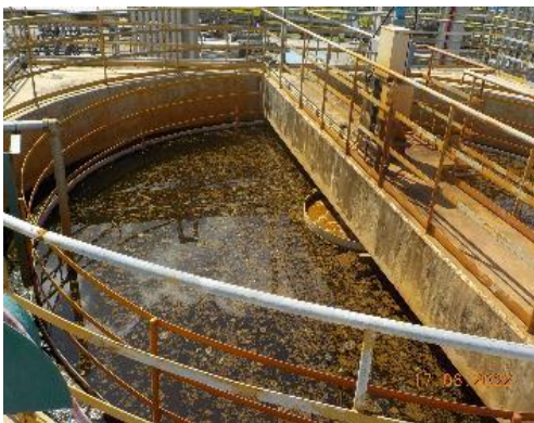
Sludge Thickener (โรงงานที่ 3)
